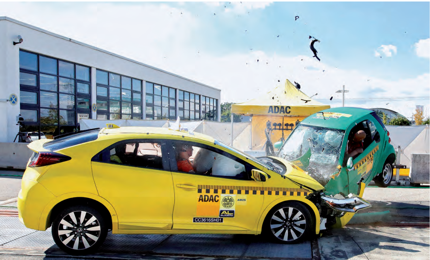
» Abb. 9 Deformationsbild nach einem Crashtest zweier Pkw, die mit jeweils 56 km/h aufeinander zube- wegt wurden, bei 50 % Überdeckung
